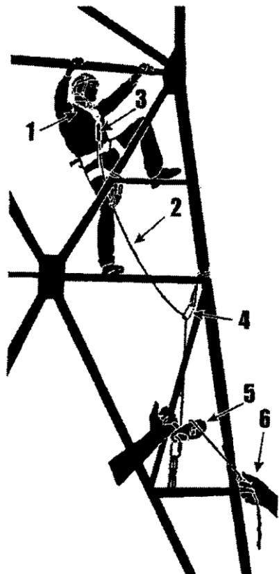
Работник обязан осуществлять организацию временных анкерных точек с фактором падения не более 1 (**схема 1** приложения N 8), при перемещении по конструкциям и высотным объектам с обеспечением своей безопасности вторым работником (страхующим).
